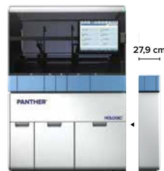
El módulo de ampliación MTU es una actualización del sistema Panther que se instala *in situ* en el laboratorio.
