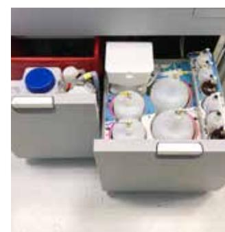
El módulo de gestión continua de líquidos/residuos es una ampliación del sistema Panther que se instala *in situ* en el laboratorio.
