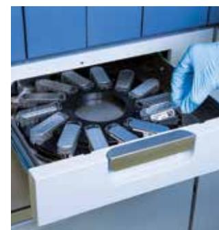
Tiene una capacidad para un máximo de 32 kits (28 kits de Panther Fusion + 4 kits de Aptima) y proporciona flexibilidad para la consolidación de pruebas en una sola plataforma.
